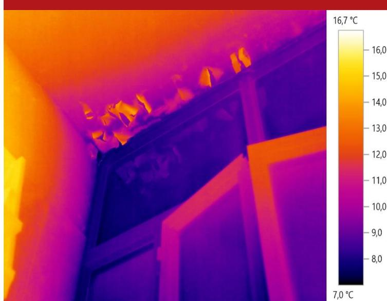
Gli scollamenti di intonaco sul soffitto della cucina sono una conseguenza di dispersioni trascurate nel tempo. L'azione costante di raffreddamento delle superfici, a causa della migrazione di calore, porta a questo tipo di criticità estetiche. La finestra della cucina è un elemento particolarmente problematico: infissi e serramenti disperdono energia termica, come si evince dai forti contrasti cromatici. Si osserva anche ingresso di aria fredda (spifferi) lungo i profili.
